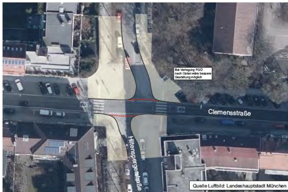
Abb. 5-4: Beispielhafte Anwendung des Prinzips des Rechts-Links-Versatz auf den Knotenpunkt Clemensstraße / Hiltenspergerstraße, (Darstellung PGV auf Grundlage Luftbild der LHM)
