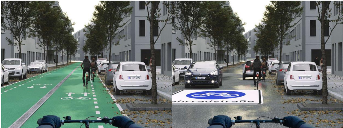
Abb. 2-8: 98 % der befragten Radfahrenden fühlen sich in einer Fahrradstraße mit parkenden Autos rechts bei einer kompletten Grünfärbung der Fahrbahn „sicher oder sehr sicher“, ohne Grünfärbung sind es 45 % (FIXMYBERLIN TEAM 2020)
