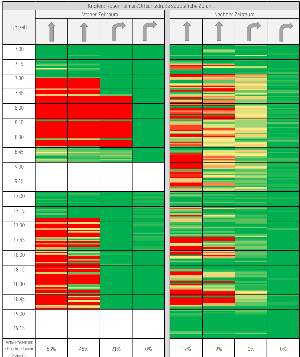
Abbildung 11: Vergleich Staulängen am Knotenpunkt Rosenheimer / Orleanstraße in der südöstlichen Zufahrt (grün = 0 gestaute und nicht abgeflossene Kfz, rot = 15 oder mehr gestaute und nicht abgeflossen Kfz)
