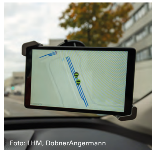
Übermittlung der Kreuzungstopologie und Signalphasen ins Fahrzeug
